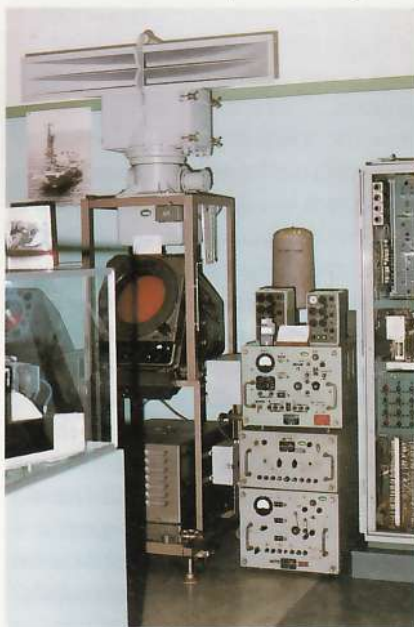
Links een radarinstallatie Decca-12, rechts daarvan een installatie IVV (Identificatie Vriend Vijand).
